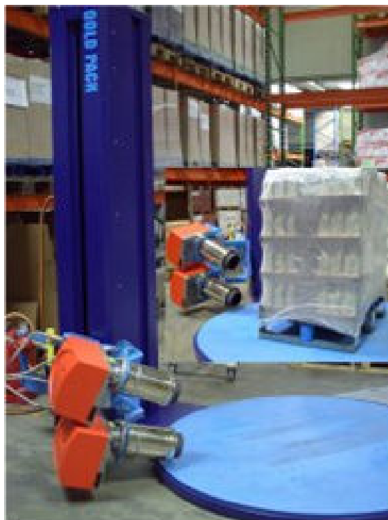
Paletten-Schrumpfgerät, Goldpack OP 133 SW, Bj. 2005 shrink packaging machine, Goldpack OP 133 SW, made 2005
